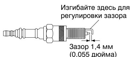
Рис. 12. Регулировка зазора свечи зажигания, нагреватель мощностью 10 кВт
